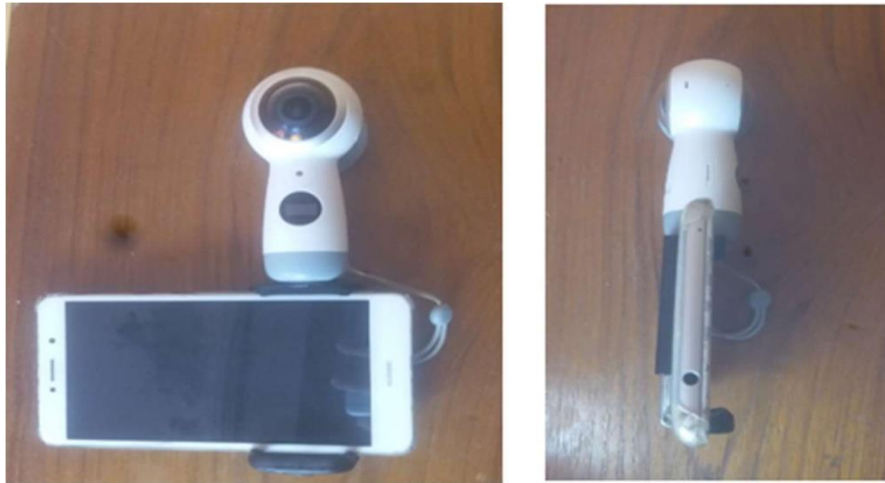
Figure 1 : montage de la caméra avec le smartphone
