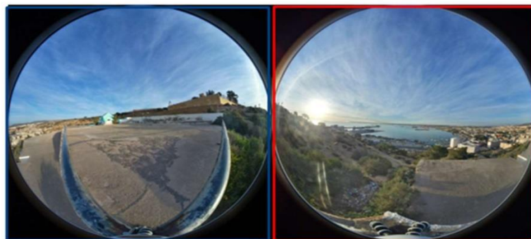
Figure 2 : Panorama avant assemblage (en rouge : image vers l'avant, en bleu vers l'arrière)
