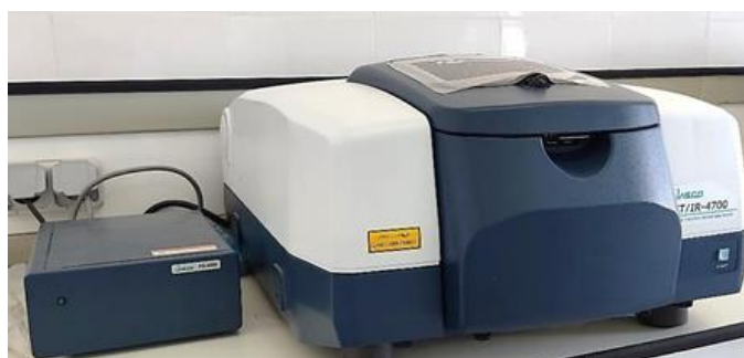
Figure II.18 : Spectroscopie à Transformée de Fourier de type Jasco FTIR-4700.
