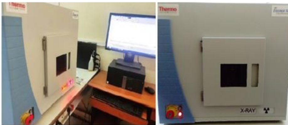
Figure II.16 : Dispositif de diffraction des rayons X de type Thermofisher
