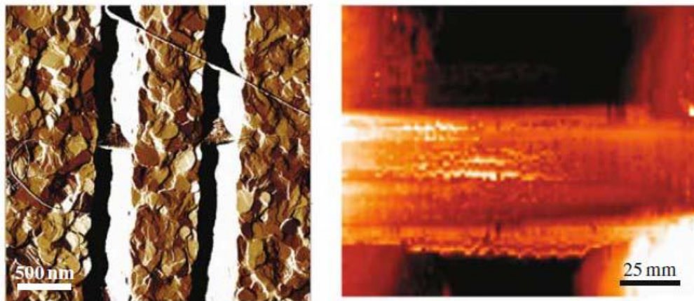
Figure II.3. (a) Image de microscopie à force atomique d'un nanotube de carbone mono-paroi synthétisé sur un substrat tranché de platine (Pt). (b) Image de microscopie à effet tunnel de la partie suspendu du nanotube [61].
