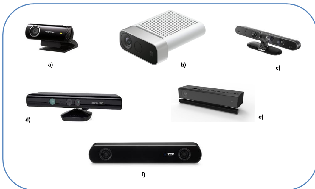
FIGURE 2.17 – Quelques exemples de caméras de profondeurs. a) Creative Camera1. b) Azure Kinect DK. c) Xtion Pro2. d) Kinect. e) Kinect 2.f) Zed3 camera
