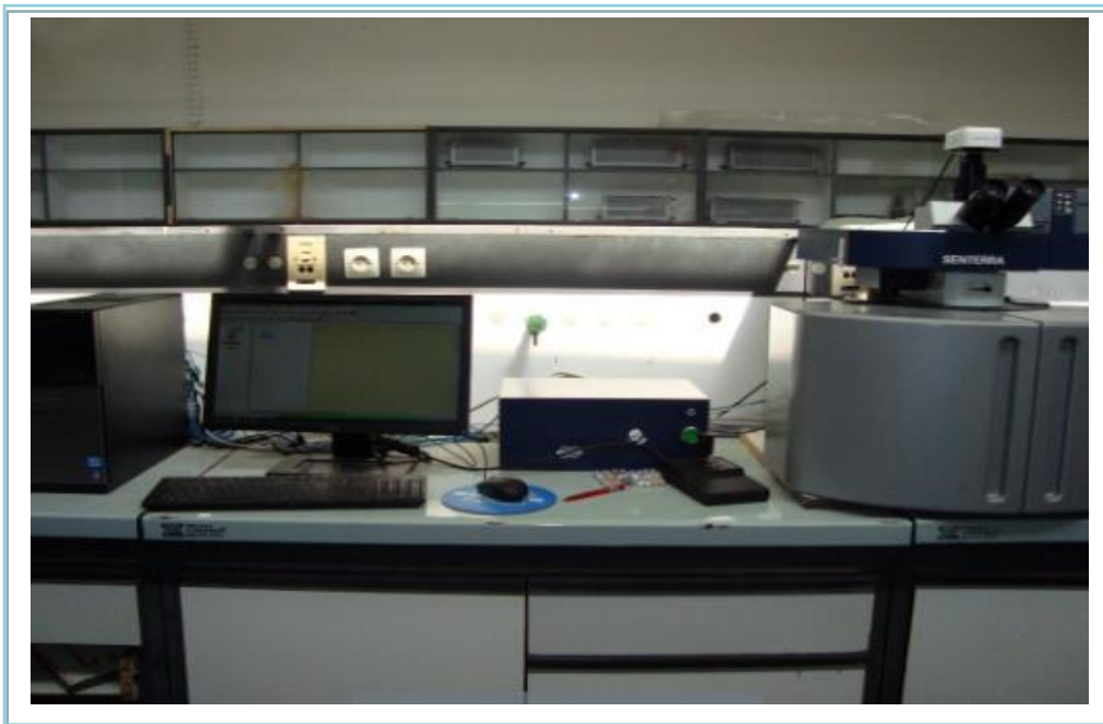
Figure III.21 : spectroscopie Raman type (Renishaw Invia), (Université des Frères Mentouri, Constantine).
