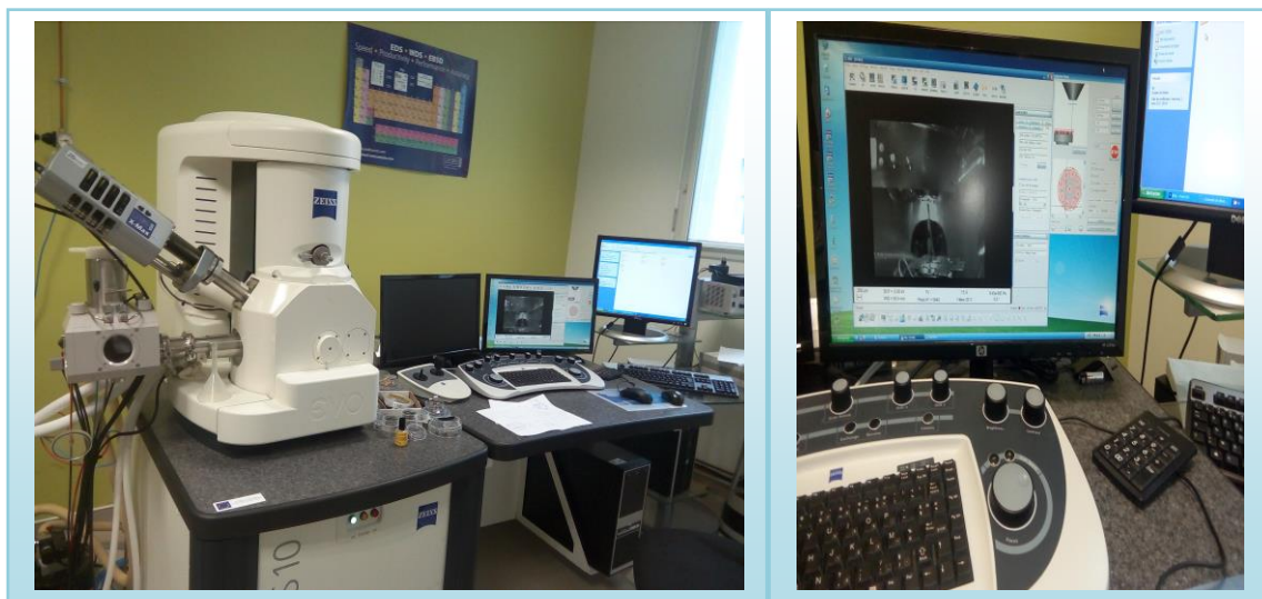
Figure III.19 : Spectroscopie EDXS de type (ZIESS EVO LS 10), (Laboratoire Moltech-Anjo Université d'Angers, France)
