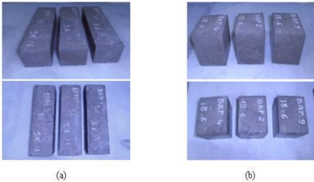
Figure 3.6. Formes des éprouvettes utilisées (a) 7x7x28 cm 3 , (b) 10x10x10 cm 3
