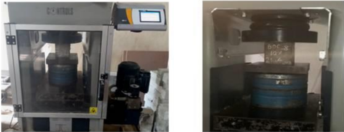
Figure 3.10. Essai de résistance à la compression.
