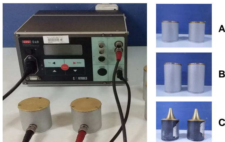
Figure 3.8. Dispositif ultrasonique et transducteurs utilisés.
