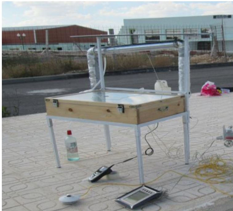
Figure II.14: Condenseur à un seul tube, (test du 04/06/2014).
