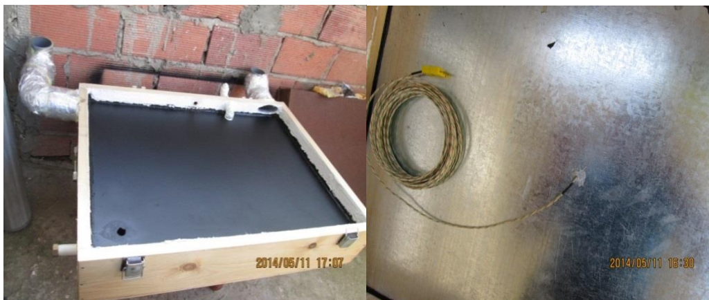
Figure II.4: Plateau absorbeur en acier galvanisé.
