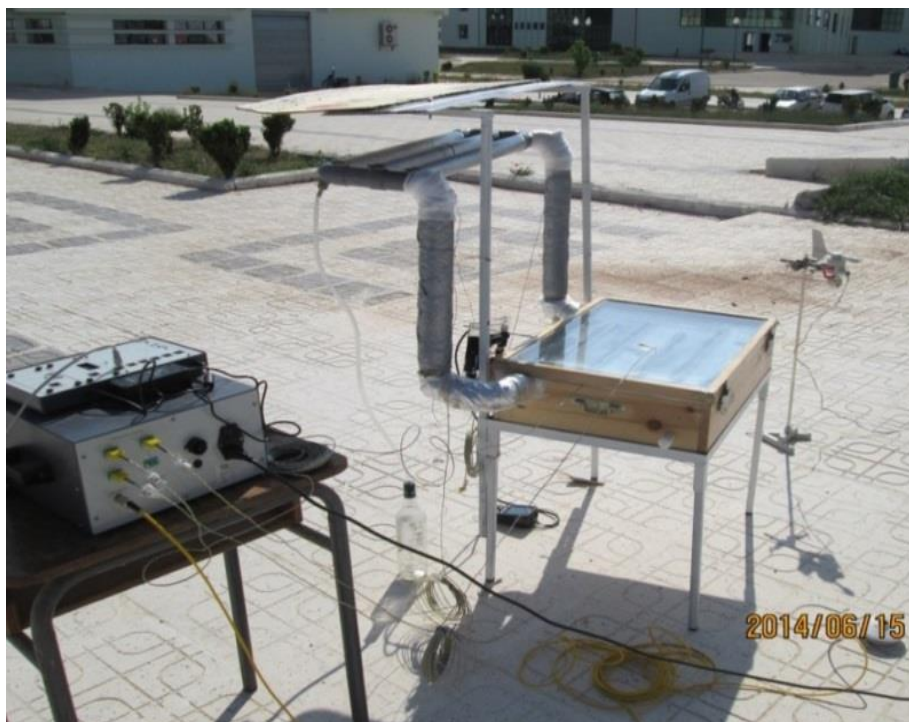
Figure II.16: Distillateur avec condenseur à trois tubes, (test du 08/06/2014).
