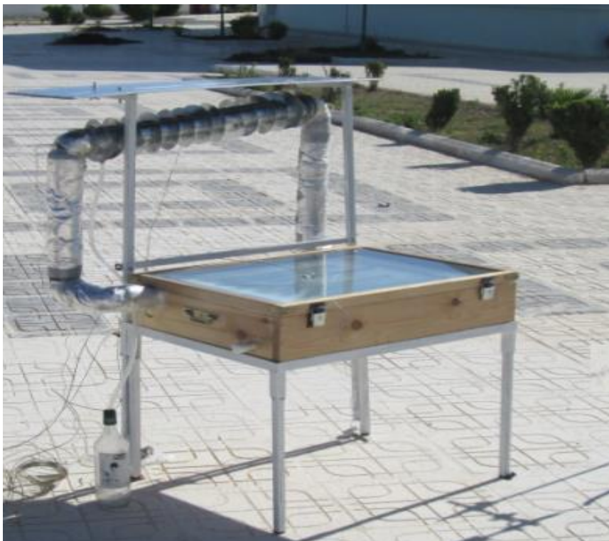
Figure II.15: Distillateur avec condenseur à tube aileté, (test du 05/06/2014).
