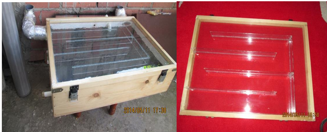
Figure II.5: Chicanes de verre collé à la vitre de distillateur.
