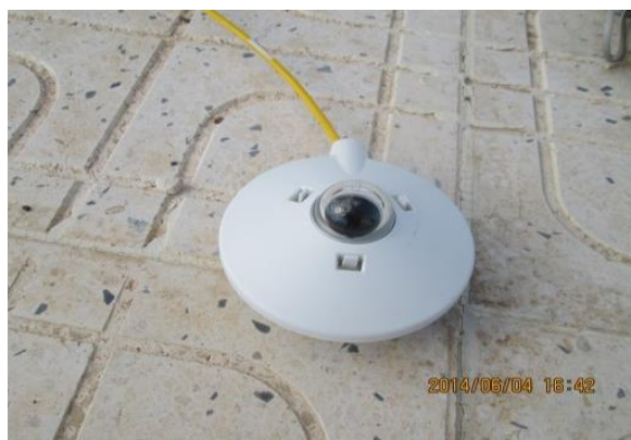
Figure II.8: Pyranomètre pour la mesure de rayonnement solaire horizontal.
