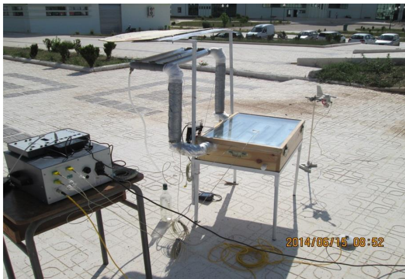
Figure III.1: Installation expérimentale pour l'étude du distillateur solaire.
