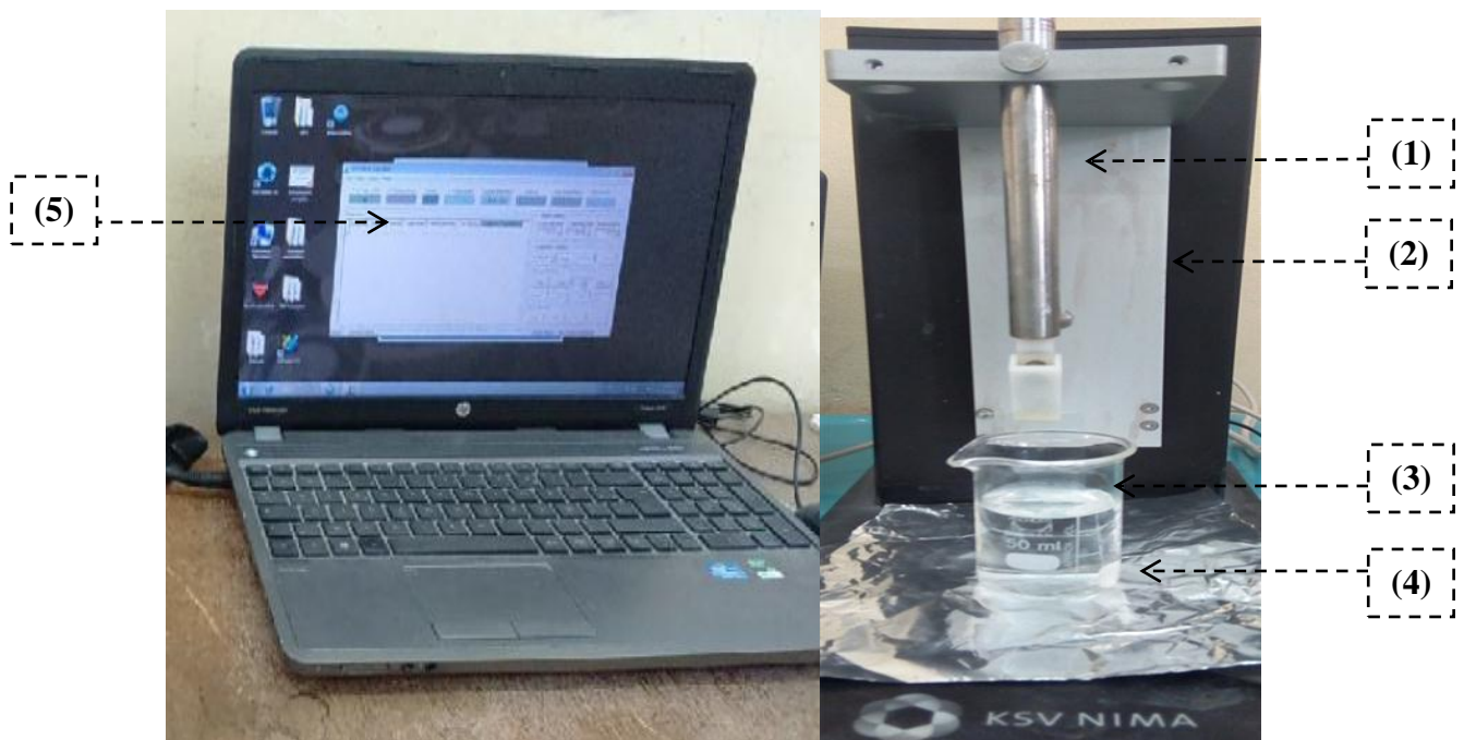
Figure III.1: Photographie du dispositif permettant le dépôt de revêtements par dip-coating des échantillons.
