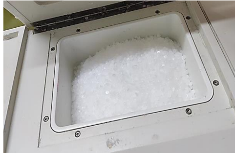
الشكل 36: الجزء الساخن من جهاز التضمين.
