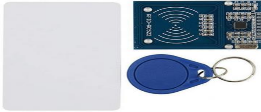
Figure. II. 6: Un module RFID est accompagné de deux badges de formes différentes l'un se forme d'une carte et l'autre d'une clé.[25]
