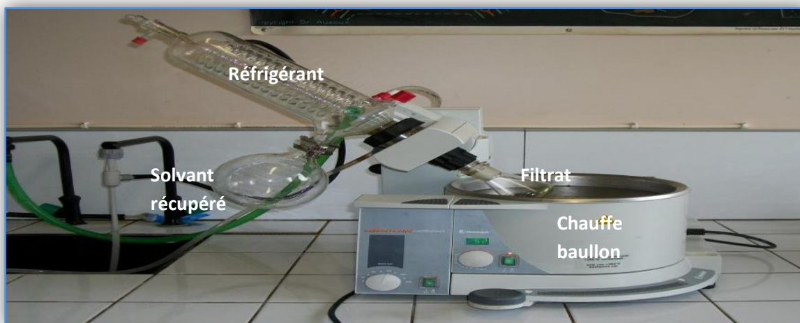
Figure 37: Photo de rotavapeur utilisé pour concentrer sous vide les différents extraits bruts des deux plantes.
