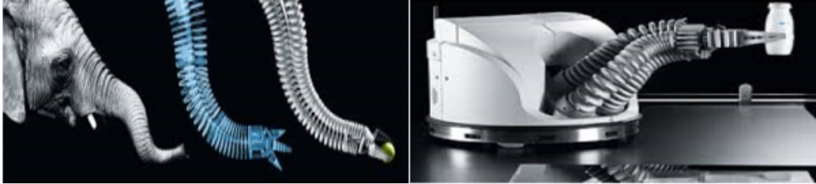
FIGURE 1.14 : (Gauche) Bionic Handling Arm (BHA) [38], (Droite) RobotinoXT : la trompe bionique "Compact Bionic Handling Assistant (CBHA)" montée sur le robot omnidirectionnel "Robotino" [37]
