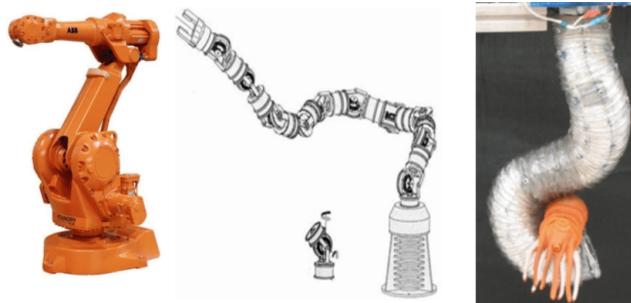
FIGURE 1.1 : Évolution des robots manipulateurs à segments rigides aux manipulateurs continuum [10, 12, 13]
