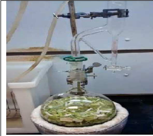
الشكل: التركيب التجريبي للتقطير بـ Hydrodistillation
