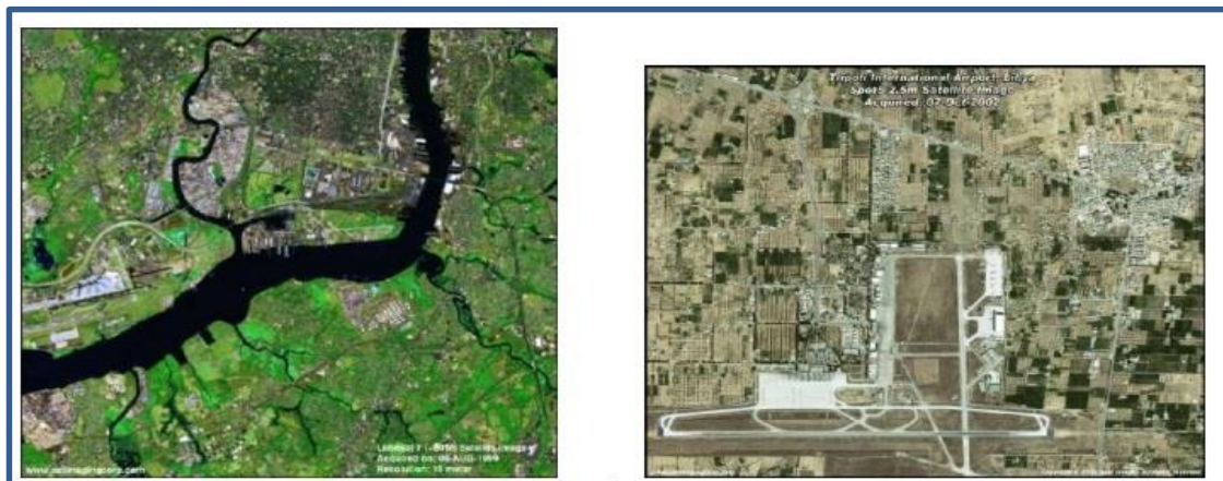
Figure 13 : À gauche, une image LANDSAT 7 de Philadelphie, États-Unis, d'une résolution de 15 m, et à droite, une image SPOT 5 à haute résolution de 2,5 m de l'aéroport de Tripoli, Libye.
