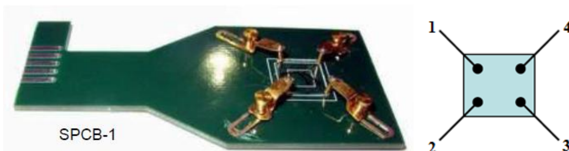
Figure III.24 : Configuration d'une mesure Van der Pauw et effet Hall.
