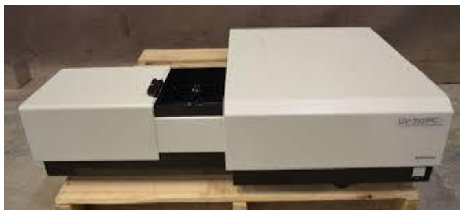
Figure III.12 : Dispositif expérimental de la spectroscopie UV-visible. (Univ. Larbi Ben M'hidi d'Oum El Bouaghi)
