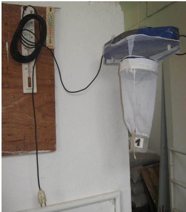
Figure 36 : Photographie représente le modèle original de piège lumineux ultraviolet (LVR, Tizi Ouzou) . (Cliché personnel, 2013)
