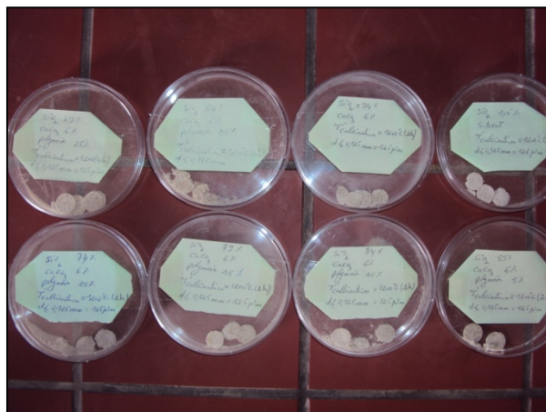
Figure III. 15 : Photographie des échantillons préparés avec des pourcentages différents de sciure d'Eucalyptus Globulus et du sable brut.
