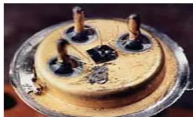
Fig.I.5 Le premier transistor MOSFET, conçu par MM Atalla, D. Kahng [17].
