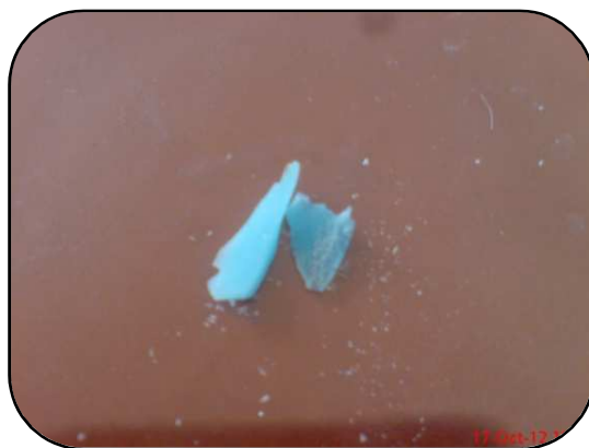
Figure III.2 : Silicate de sodium préparé à partir du quartz naturel.
