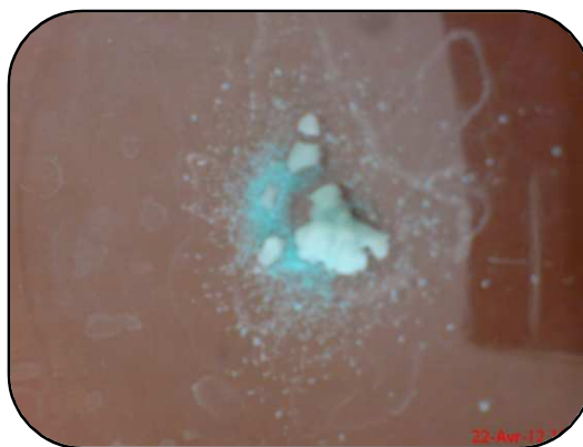
Figure III.5 : Les gels de silice formés à partir du quartz naturel.
