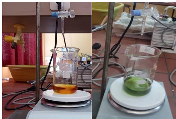
Figure 19. Titration de la solution sol avec le sel de Mohr et changement de la solution de la couleur orange - brun vers le vert.
