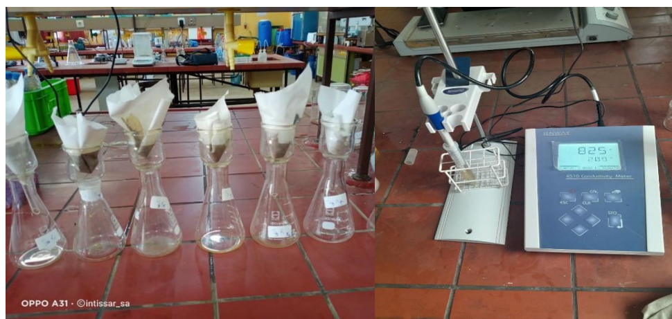
Figure 16. Filtration de la solution sol/eau et mesure de la CE de l'extrait obtenu.
