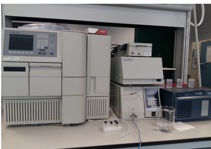
Photographie 6 : Isolement et collecte manuelle des molécules purifiées par HPLC analytique.
