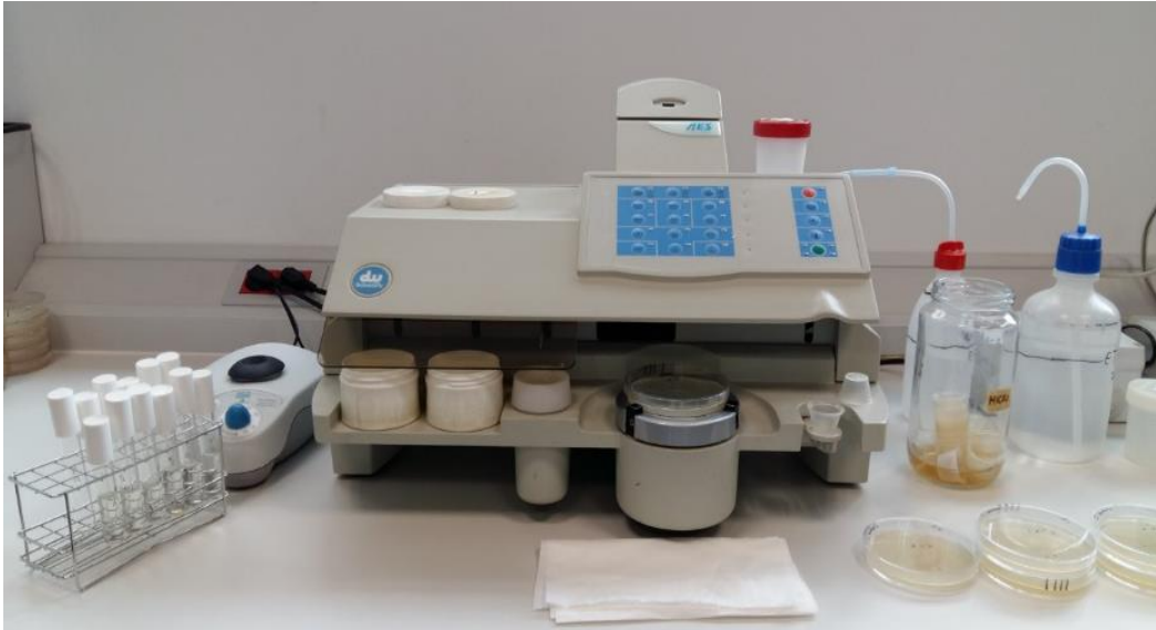
Photographie 7 : L'ensemencement automatique ( Spiral-plater ).
