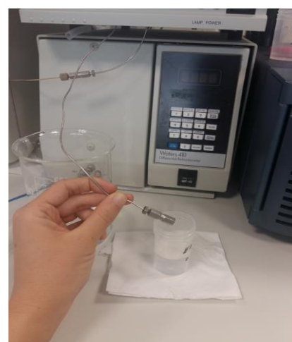
Photographie 6 : Isolement et collecte manuelle des molécules purifiées par HPLC analytique.
