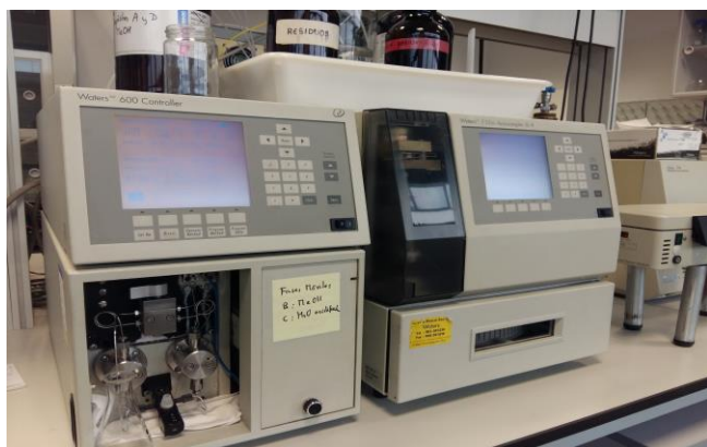
Photographie 3 : Le système chromatographique utilisé.
