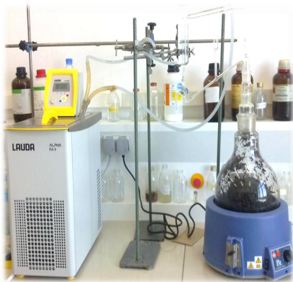
Figure 9 : Montage d'extraction des huiles essentielles de type Clevenger
