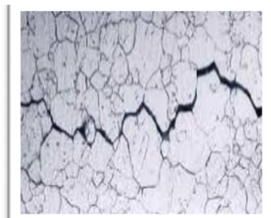
Figure II. 3. Structure métallurgique touchée par la corrosion inter-granulaire
