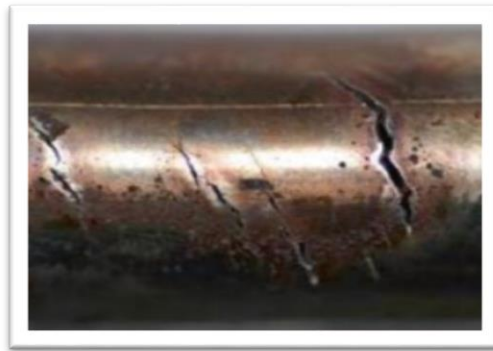
Figure II. 7. Corrosion sous contrainte d'un tube en acier inoxydable [11]
