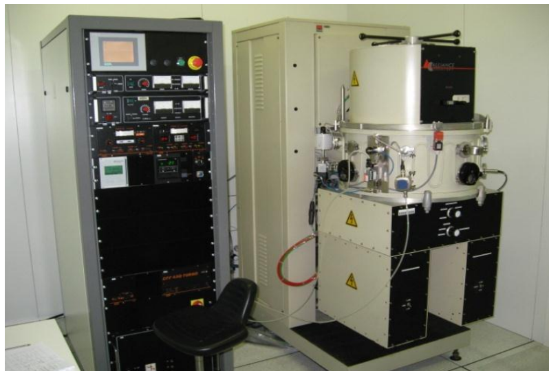
Figure II. 18 : Photo du bâti de pulvérisation cathodique magnétron AICATEL de type : SCM600 de l'INL
