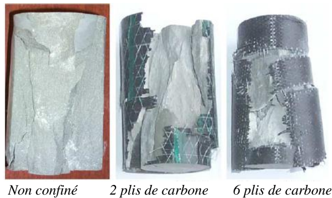
Figure IV – 16 : Rupture des éprouvettes en BHP confiné par PRFC [Berthet et al 2005]
