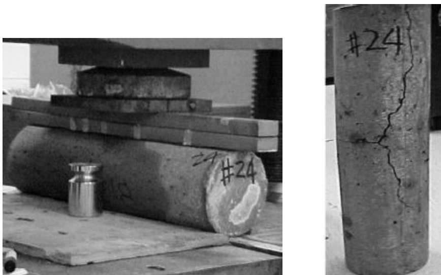
Figure IV - 32: Essai de fendage (gauche) et éprouvette endommagée (gauche) [G.Li et al 2003 a]
