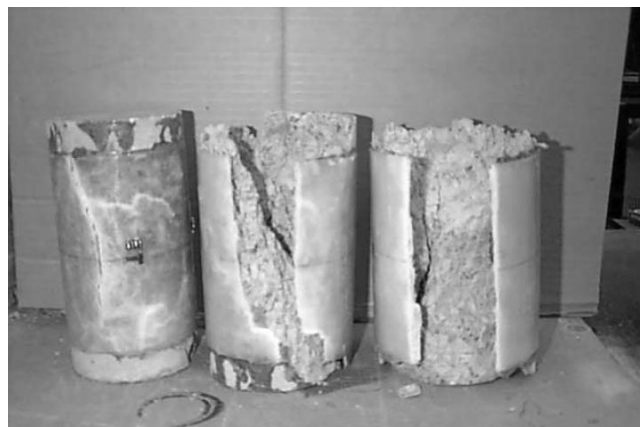
Figure II -20 : Modes de rupture d'un béton renforcé par un FRP à base de fibres de verre et de résine époxy soumis à une charge de compression [Lau et al., 2001].
