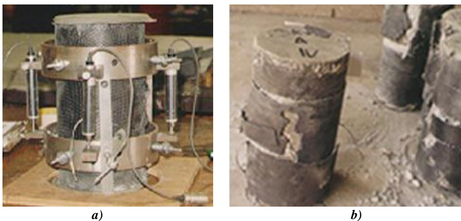
Figure IV - 4: a) Instrumentation ; b) mode de rupture [Shahawy et al 2000]
