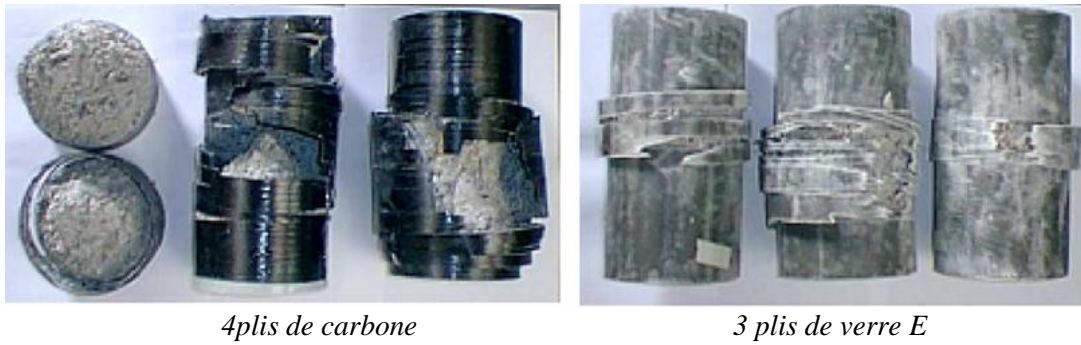
Figure IV – 15 : Rupture des éprouvettes en béton ordinaire confiné par PRFC et PRFV [Berthet et al 2005]
